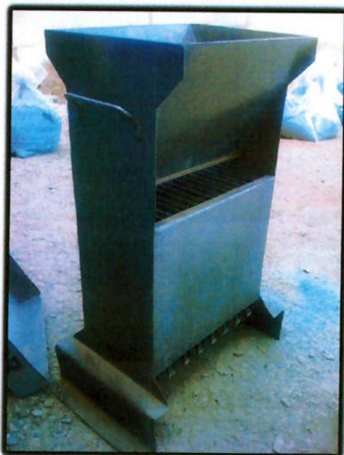
Figura 12 – Quarteador Jones e amostras prontas para análise.
